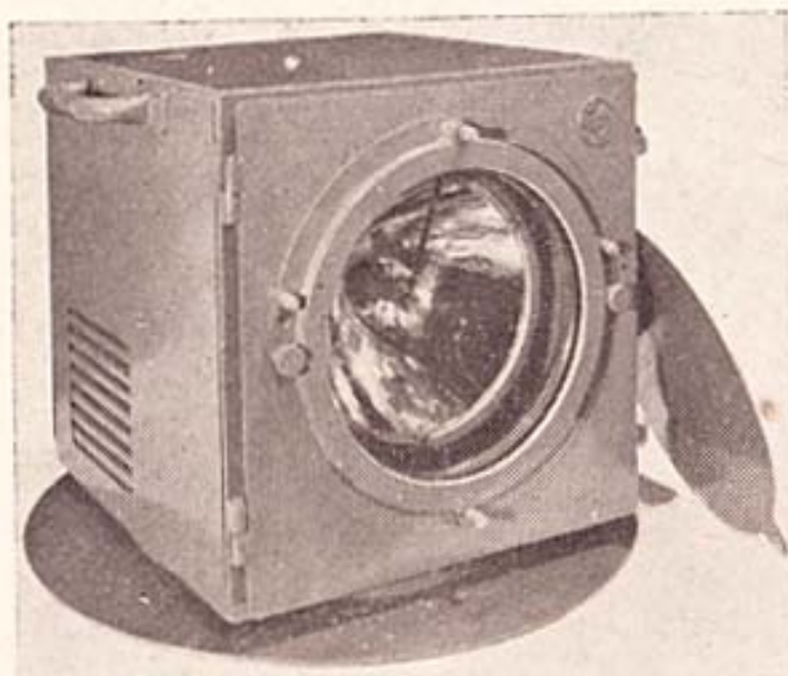
Afb. 54. Draagbaar en horizontaal oriënteerbaar zoeklicht met ingebouwden voedingstransformator en koelinstallatie, voorzien van lamp SP 500 W 40/1,4, met afgenomen afsluitplaat. Maximum lichtsterkte van den concentrischen lichtbundel ca. 5 000 000 k.
