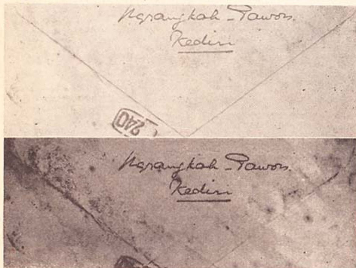
Afb. 47. Foto van een wederrechtelijk geopende en later weer dichtgeplakte enveloppe. Boven: bij normaal licht; onder: bij ultra-violette bestraling met een superhoogedruk-kwikanalyselamp type HPW. (Foto C. J. Tirion, Den Haag).
