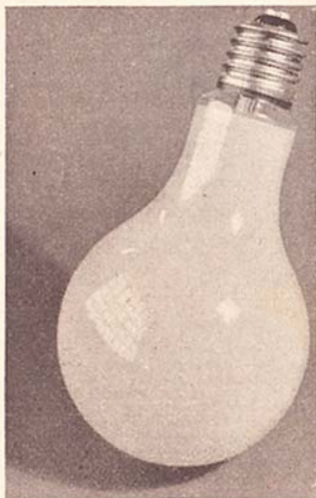
Afb. 44. Superhoogedruk-kwiklamp met kleurcorrectie type HPL 500, 125 V/143 W, 220 V/132 W, 500 Dlm.
