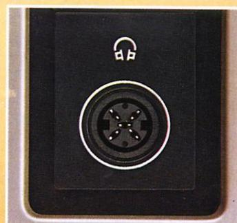
Unterhalb des Programm-Sensors befindet sich die Schaltbuchse für einen Kopfhörer. Sie können fernsehen, ohne andere zu stören.
